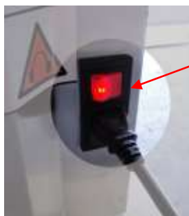
Contacteur en position ON (illuminé).
