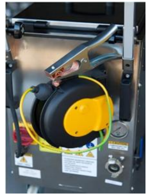
Dérouleuse de tresse de masse 7m / Ø6²
