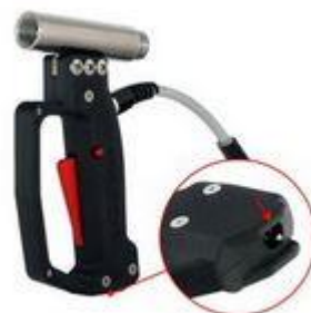
Pistolet SMART HD avec commutateur "Air Only"
