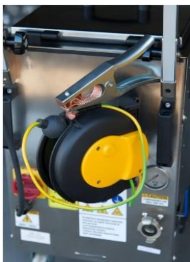
Dérouleur de tresse de masse: -longueur : 7 mètres -section : 6mm 2
