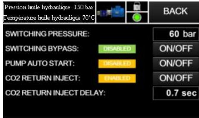
. L'option "PRESSION DE COMMANDE" est la pression à partir de laquelle la machine passera de l'accumulation de carboglace à l'extrusion des pellets. L'accumulation de carboglace est nécessaire pour empêcher le CO2 de fuir à travers la matrice et pour aider à former les pellets. Si, pendant l'extrusion, le cylindre dépasse la pression de commande (réglée en usine à 60 bars), le piston parcourra toute la longueur de la chambre et commencera l'extrusion des pellets.
