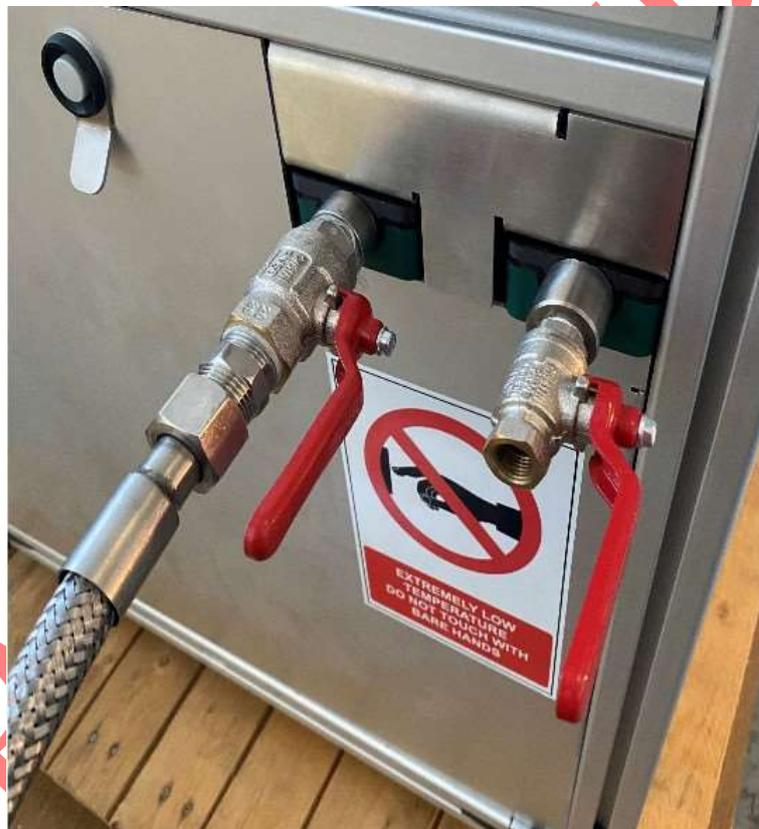
Vanne d'alimentation CO<sub>2</sub> à gauche, vanne de dépressurisation à droite.
