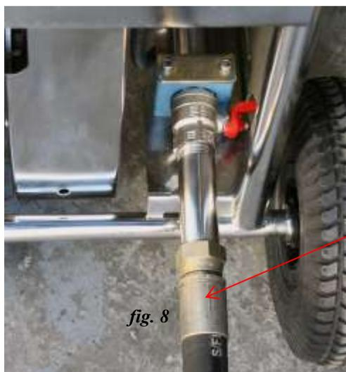
**F: Tuyau d'air comprimé (option)**
