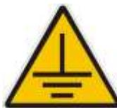
Le Nettoyage Cryogénique génère de l'électricité statique. Les SMART sont équipées d'un câble de mise à la terre. Ce câble doit toucher le sol ce qui évite que l'électricité statique ne traverse le corps de l'opérateur. Assurez-vous aussi que les objets à nettoyer sont
