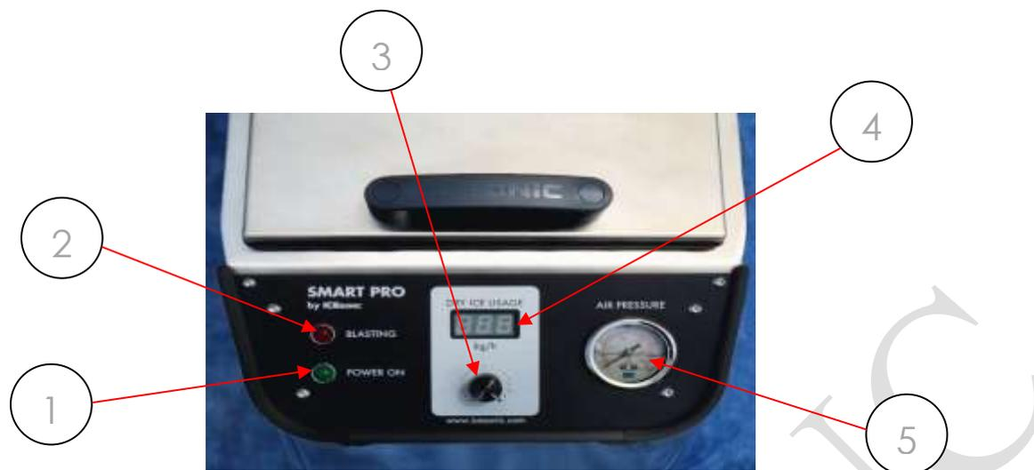
1. Power "ON" : s'allume quand SMART est sous tension
