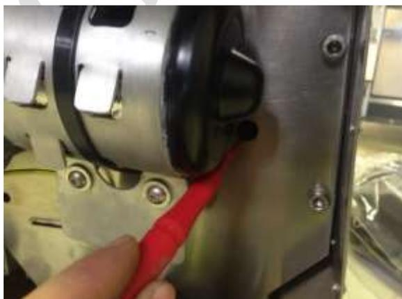
4. La fréquence du vibreur peut être ajustée en tournant la flèche du potentiomètre à l'aide d'un tournevis fin..
