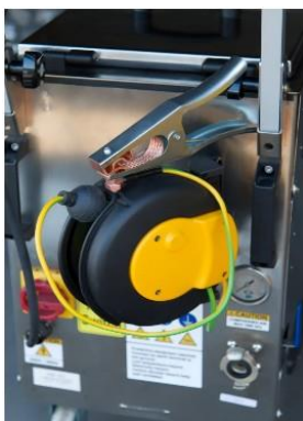
de masse: longueur : 7 mètres section : 6mm 2
